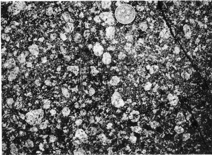
**Figure 14.** Plagioclase glomeroporphyritic sill. (GSC 190570)
